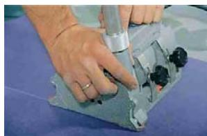
Герметизация швов сварочным шнуром осуществляется с помощью аппарата для ручной сварки со специальной насадкой 5 мм. Температура сварки составляет 400-450 °C, скорость примерно 4-5 метров в минуту.
